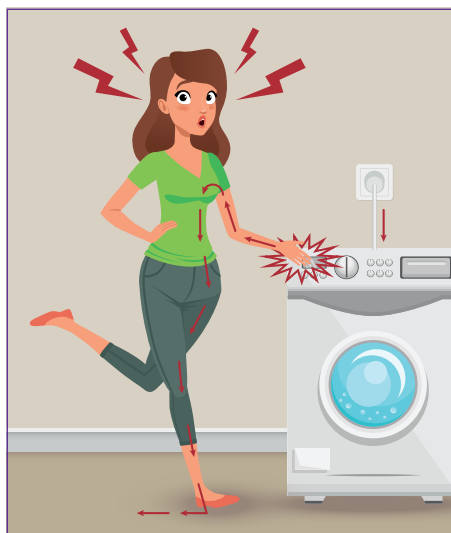
Contact indirect avec des éléments sous tension suite à un défaut d'isolement à la terre
