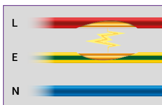
Défaut d'arc à la Terre
