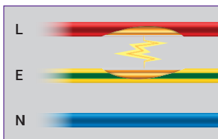
Défaut d'arc à la Terre
