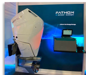
Moteur électrique pour hors bord (Mercury) 65 CV, 1h d'autonomie.
