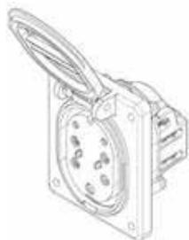
– **pour les points de connexion à usage professionnel installés sur des espaces extérieurs**, les prises de courant doivent être munies d'obturateurs et peuvent être conformes à la norme EN 60309-1 ou à l'EN 60309-2.
